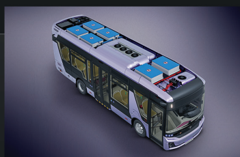
Batterie TemsaTech 8x48 kWh, autonomia 600 km
