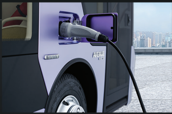
Cargador enchufable de 300kW
